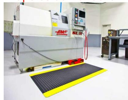
A menos que o sistema de revestimento tenha sido especificado para fornecer resistência em áreas sujeitas ao impacto, a utilização de tapetes de borracha nas áreas sujeitas ao impacto irá reduzir os custos com reparos dispendiosos.
